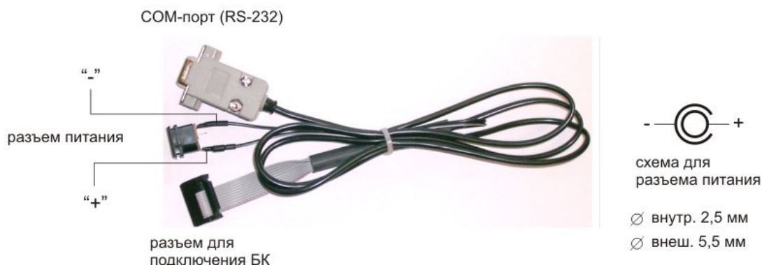
рис. 1. Рекомендуемый адаптер К-линии ШП-1 для перепрограммирования БК.
